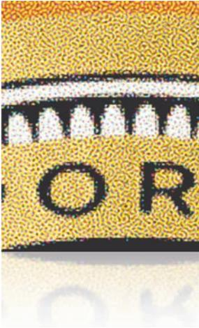
Dependiendo del tamaño del punto, este sistema de impresión es capaz de reproducir imágenes que aparentan ser de "tono continuo". Sin embargo, para que el tramado estocástico dé buenos resultados, la prensa a ser usada debe estar en óptimas condiciones, ya que el tamaño del punto es crítico.
